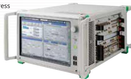
MP1900A – это высокопроизводительный измеритель коэффициента битовых ошибок с различными возможностями расширения, позволяющий проводить оценку указанных высокоскоростных интерфейсов на физическом уровне. Благодаря своей многофункциональности, MP1900A идеально подходит для оценки на ранней стадии проектирования характеристик всех интерфейсов, от сетей Ethernet следующего поколения до межсоединений на уровне шин.
